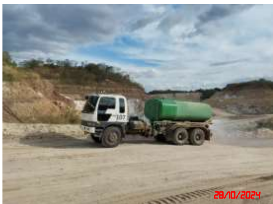
รูปที่ 6 รถฉีดพรมน้ำบริเวณเส้นทางขนส่งแร่
