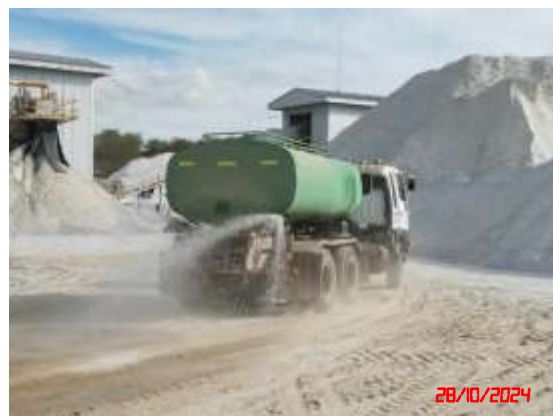
รูปที่ 6 รถฉีดพรมน้ำบริเวณเส้นทางขนส่งแร่
